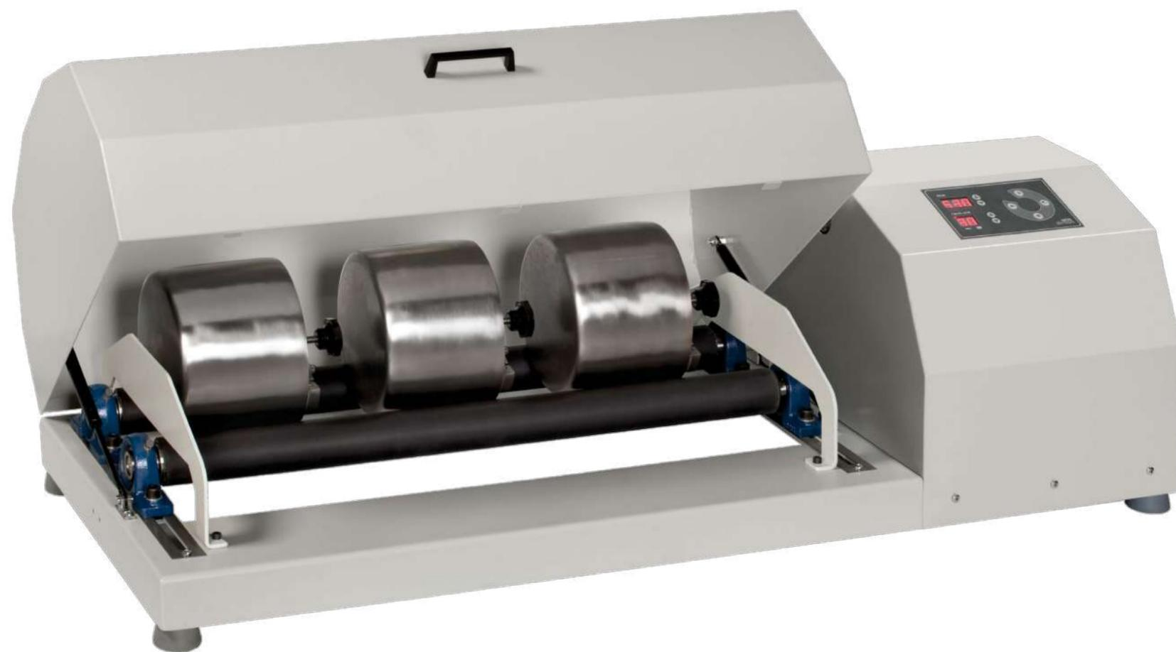
El molino de bolas OABM 255 produce el fraccionado por golpeteo de las bolas contra la muestra al describir una órbita semi-circular por arrastre del jarro en el cilindro motor. Jarros aislados que impiden la contaminación de las muestras.
