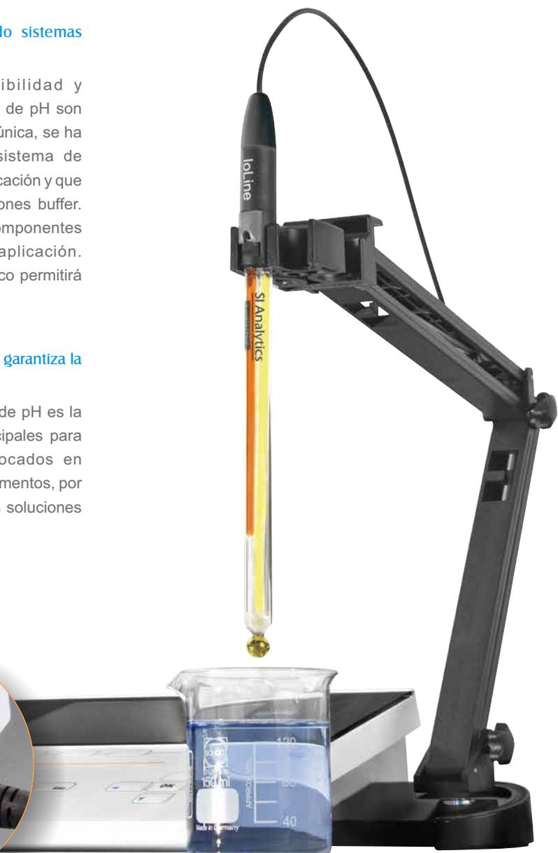
Sin embargo, aun continua la incertidumbre con respecto a los electrodos, al no saber con seguridad si el electrodo se corresponde con los datos de calibración almacenados con el instrumento. Para asegurar que la pendiente y el punto cero del electrodo correspondían a la información almacenada en el instrumento para el calculo del valor de pH, era necesario recalibrar.
