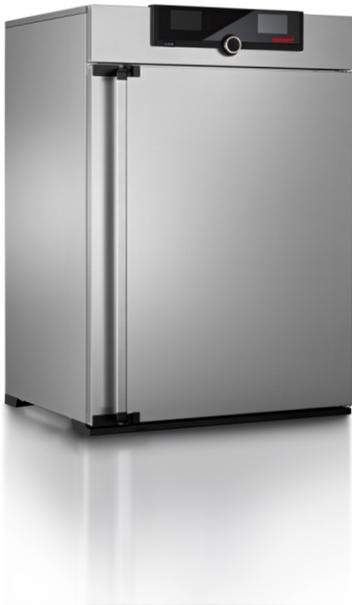
Son equipos diseñados a medida para simulaciones ambientales y ensayos de materiales de larga duración en el ámbito de la investigación, el desarrollo y los ensayos de estabilidad conformes a ICH.
